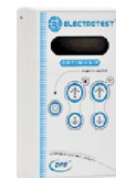
OPTIMUS 7 — контроллер настенное исполнение, 6 релейных выходов, 4 дискретных входа, 2 выхода 0—10 В, 3 входа для датчиков Т, IP30
